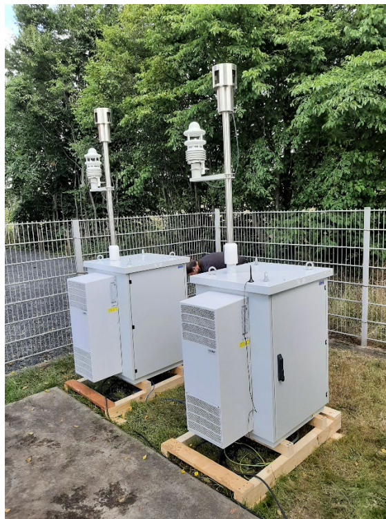
Abbildung 9: Vollklimatisiertes, wetterfestes Gehäuse Modell 199
