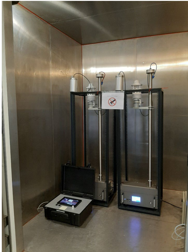
Abbildung 11: EDM 280 in Klimakammer, Dispenser angeschlossen an Probeneingang
