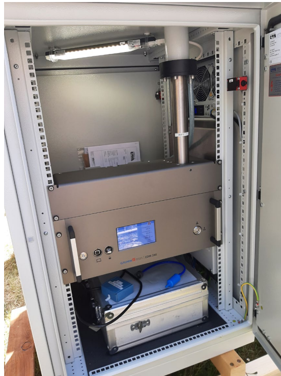
Abbildung 4: Einbau Probenrohrhalter + Messeinschub in Gehäuse Modell 199
