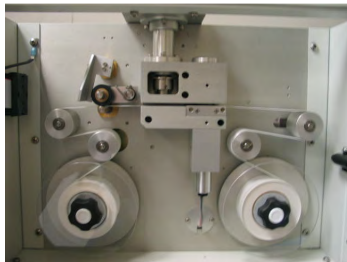
Abbildung 10: Vorderansicht BAM-1020, Frontklappe geöffnet
