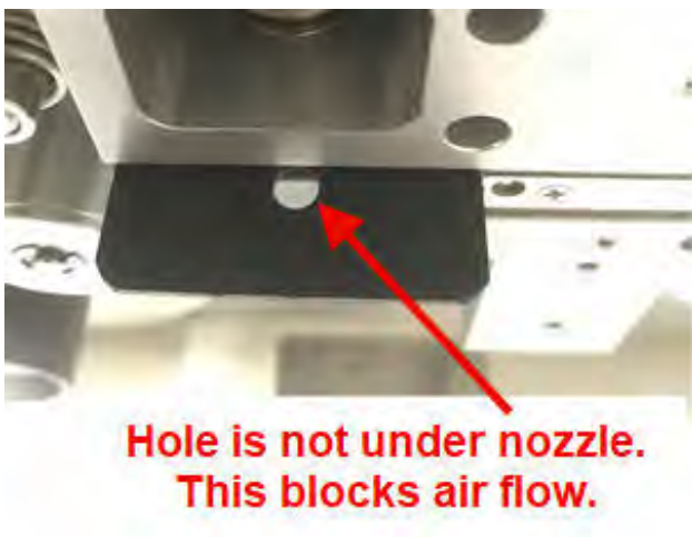
Abbildung 18 – Düsendichtungswerkzeug mit fester Seite unter der Düse
