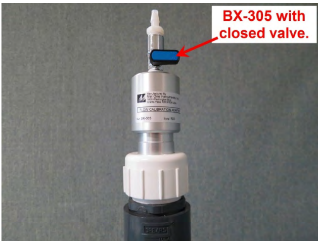
Abbildung 15 – Am Einlassrohr installiertes Leckrückschlagventil BX-305
