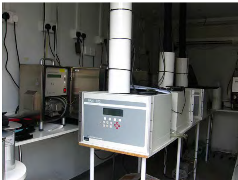
Abbildung 8: Messgeräte BAM-1020 in Messstation (2 Prüflinge aus Eignungsprüfung + 1 Prüfling zu Versuchszwecken (Heizungs- konfiguration))
