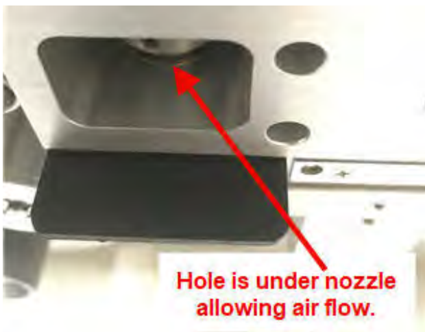
Abbildung 17 – Düsendichtungswerkzeug mit Bohrung unter der Düse
