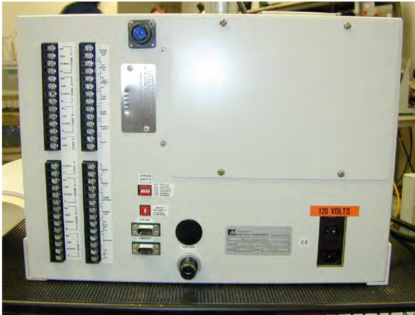
Abbildung 23: Ansicht Geräterückseite BAM-1020
