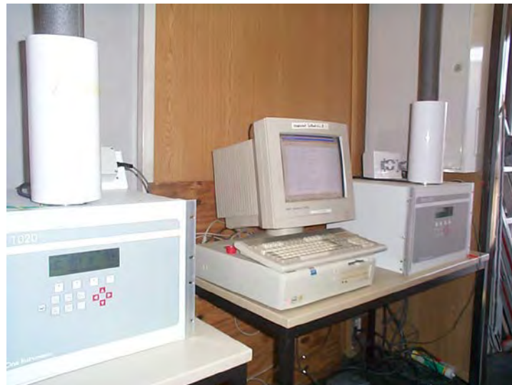
Abbildung 7: Messgeräte BAM-1020 in Messstation
