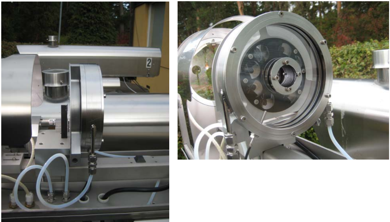
Abbildung 6: Automatische Kalibriereinrichtung (aktiver Zustand)
