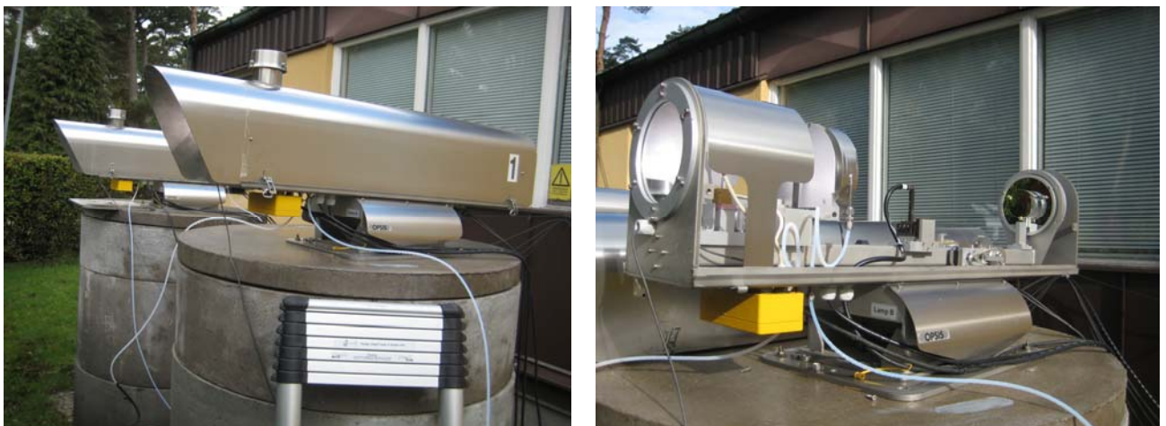
Abbildung 2: Sende-Empfangseinheit ER120 mit und ohne Abdeckung
