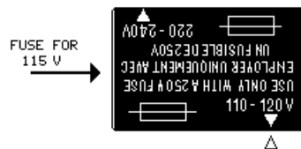
Abb. 2.2. Sicherungshalter; hier auf 115 V Netzspannung eingestellt..
