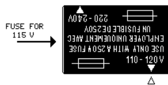
Abb. 3.2. Sicherungshalter; hier auf 115 V Netzspannung eingestellt.
